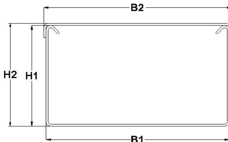
**Kabelkanal (KKGe) aus Edelstahlblech mit Endstück (KKEEn), Kabelkanalverbinder (KKVb), Kabelkanalinnenwinkel (KKWi), Kabelkanalausßenwinkel (KKWa), Kabelkanaldeckel mit Schloß (KKDe) und Kabelkanalverbindungsteile (KKVb).**
